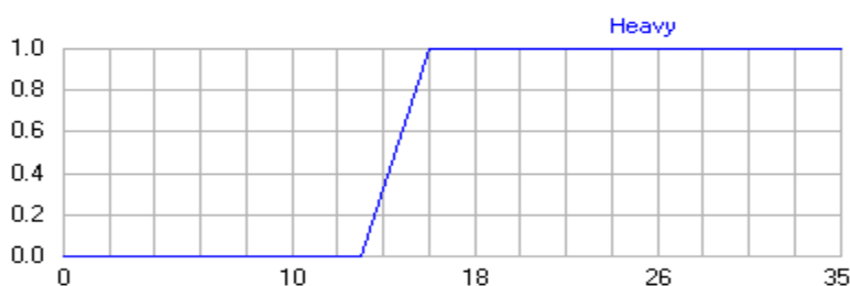
Рисунок 3 - Пример вида функции принадлежности
